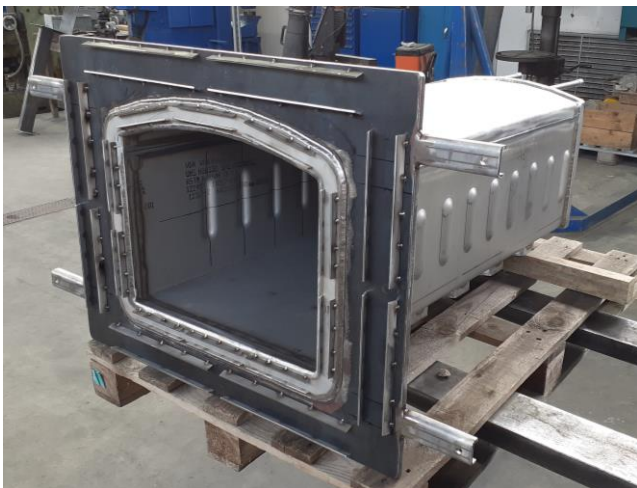
Muffola interna in acciaio refrattario a tenuta gas, di nuova fabbricazione
